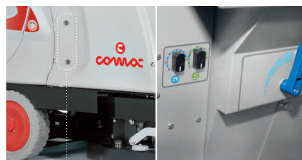
Peilaanwijzers voor de vloeistoffen (uitvoering met CDS)
