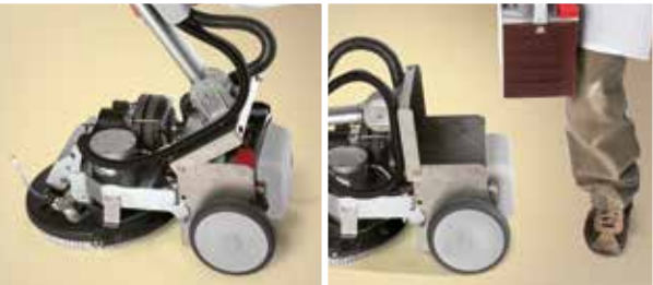
Vispa 35 B De accubehuizing is eenvoudig toegankelijk, waardoor de accu snel kan worden vervangen
