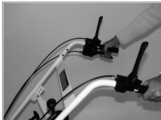
2) Tant que vous appuyez sur le levier de commande, la machine se déplace en marche arrière.
