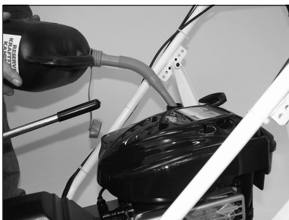
2) Tenez le bidon comme montré sur l'illustration. Ne versez qu'une petite quantité à la fois et contrôlez le niveau de remplissage.
