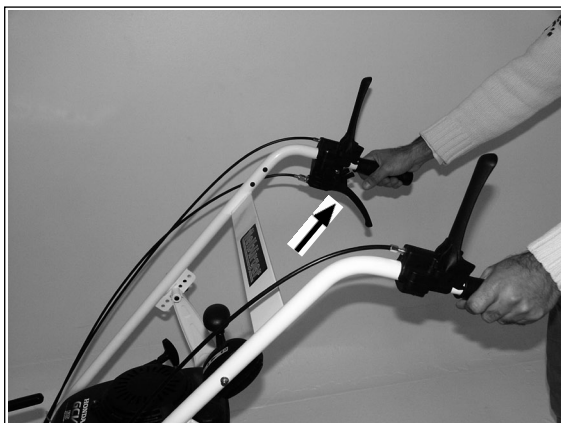
1) Le levier de commande inférieur sur la poignée droite active la marche arrière.
