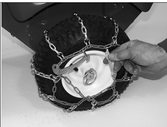
4) La chaîne mise autour de la roue et serrer la pince à travers la roue et le crochet.
