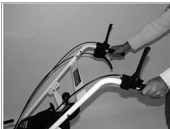
1) Sur le guidon se trouvent les leviers de commande pour l'entraînement moteur et l'entraînement des brosses de balayage.
