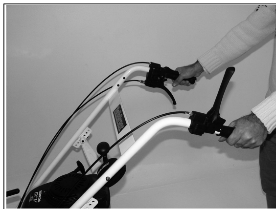
2) Pour mettre l'entraînement moteur (avance) en marche, actionner sur le levier supérieur droit
