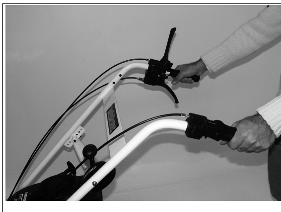
3) La brosse de balayage est mise en marche avec la main gauche.
