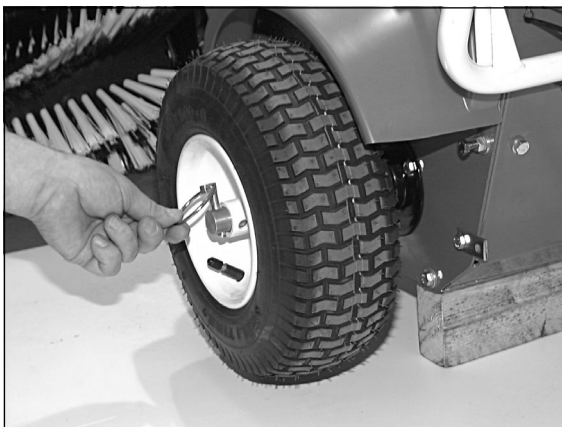
2) Lever tout d'abord la machine avec un bois équarri et puis retirer la roue.
