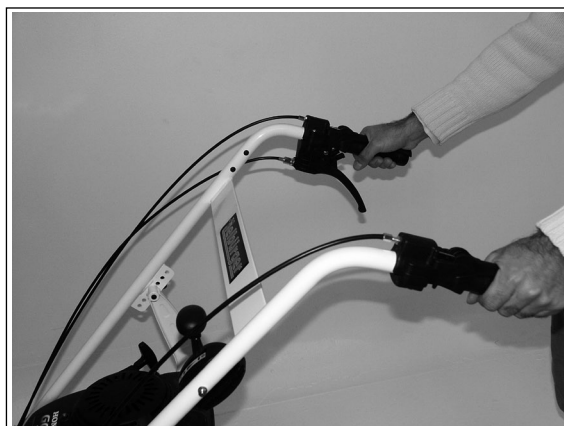
4) En actionnant les deux leviers de commande, l'entraînement de la brosse de balayage et l'entraînement moteur sont mis en marche.
