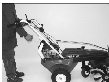
3) Tirer sur le câble de démarrage. Veillez à être derrière le guidon et en dehors de la zone de danger.
