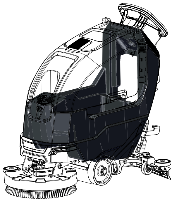
4 - RÉSERVOIR DE SOLUTION
