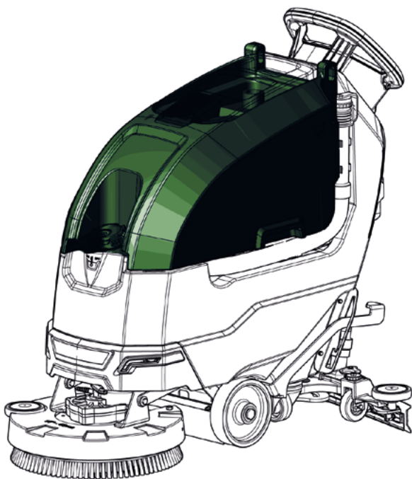
3 - RÉSERVOIR DE RÉCUPÉRATION
